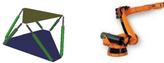
Figure 3 : Structure parallèle de Stewart - Robot « série » KR 100 P
