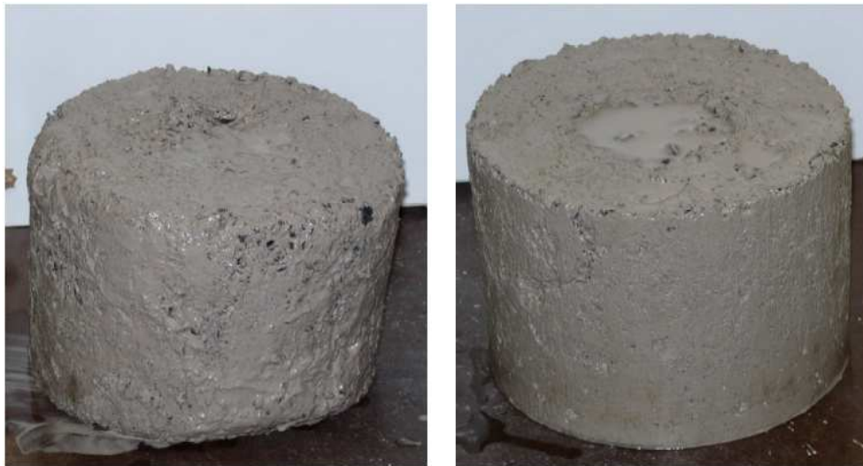
Figure 8 : Aspect d'un matériau de remblai non-essorable.
