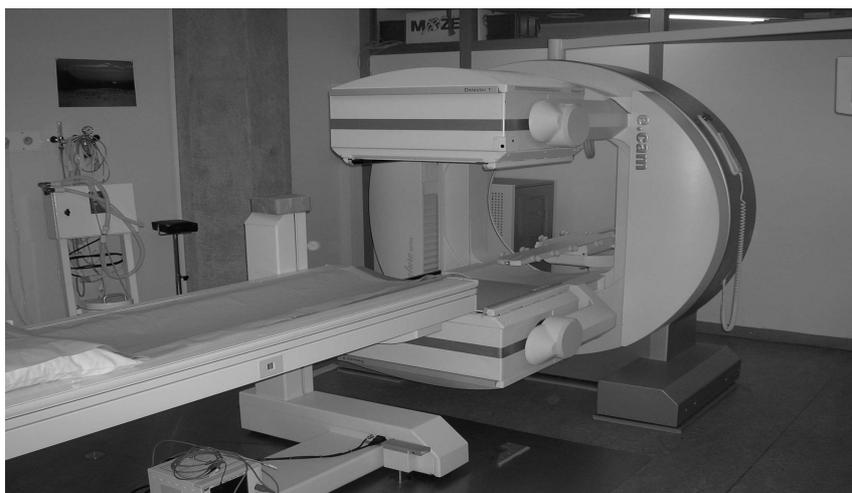
*Figure 2 : Exemple de gamma caméra: la Siemens E-CAM Signature du CHU de Liège. Elle dispose de deux détecteurs qui permettent d'acquérir les données plus rapidement en effectuant seulement un demi-tour autour du patient.*
