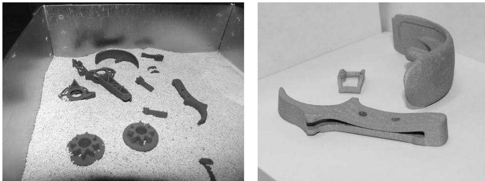
*Figure 7 : pièces frittées sur un lit d'alumine déformées après frittage.*
