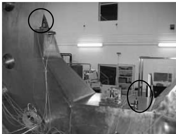
Figure 18 : Localisation des accéléromètres sur l'équerre support
