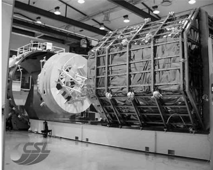
Figure 28 : Vérification des marges avec une maquette représentative du satellite
