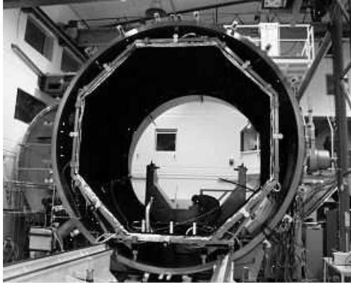
Figure 13 : Vue générale de la tente thermique installée dans la cuve Focal5
