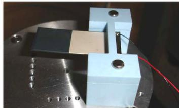
*Figure 13 : Exemple de générateur piézoélectrique [10]*
