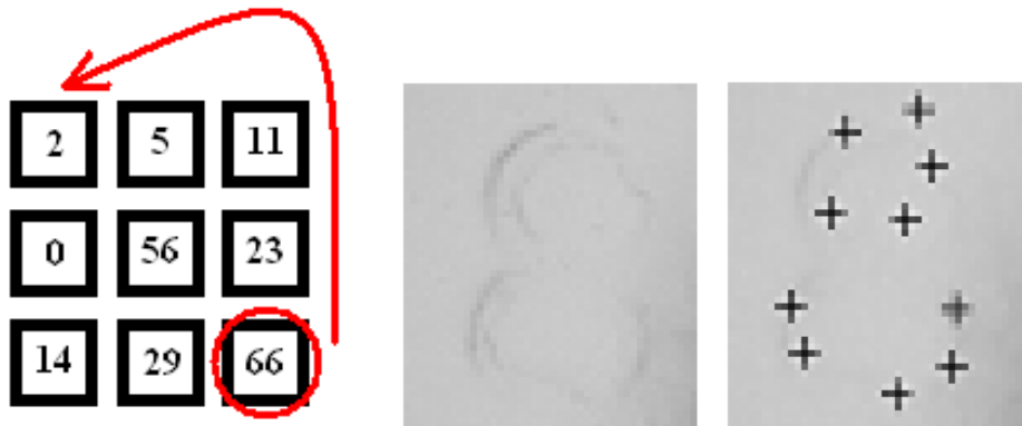
Figure 4 : Harris détecte aussi les PI d'une image pauvre en informations.
