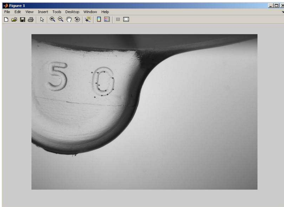
Figure 3 : Algorithme de Harris employé sur un chiffre.
