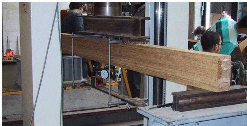
*Figure 38 : Principe d'essai pour l'étude du module d'élasticité*
