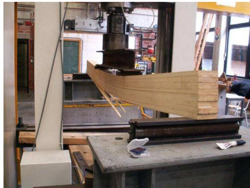
Figure 45 : Essai de rupture sur la poutre type Horizontal
