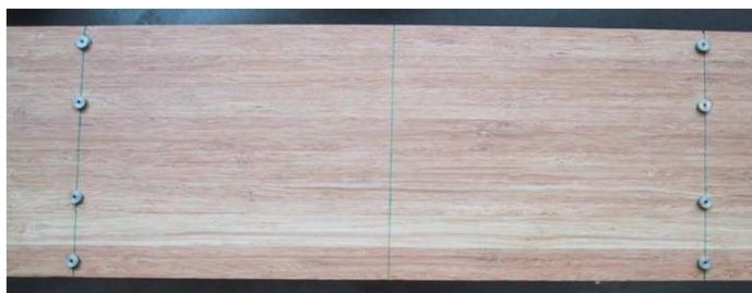
Figure 41 : Position des pastilles démecs
