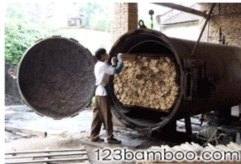
*Figure 10 : Traitement chimique des lamelles*
