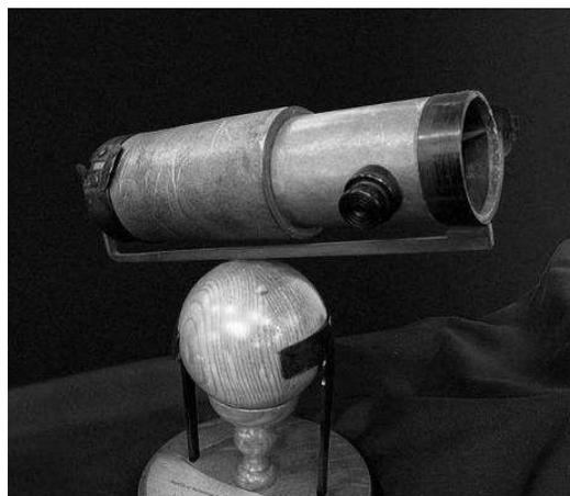
*Figure 2 : Une réplique du télescope de Newton.*
