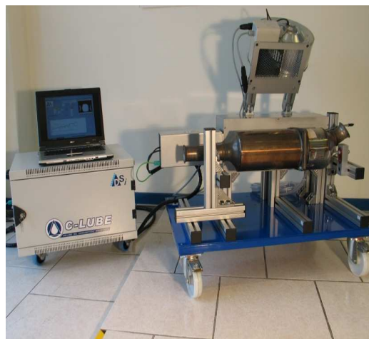
Figure 3 : le C-LUBE (mesure de consommation d'huile)
