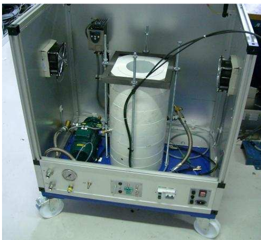
Figure 2 : la Chambre TLA (mesure d'usure de pièces)
