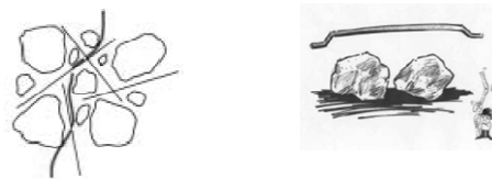
Figure 1 : Propagation des fissures empêchées [8] - [1]
