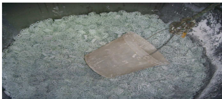
Figure 5. Photographie de l'intérieur d'une colonne : garnissage en vrac de type « Cascade mini-ring »
