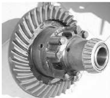
Figure 4 : Différentiel automobile muni de sa couronne d'engrenage
