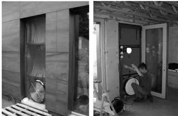
*Figure 6 : Application du Blowerdoor Test [9]*
