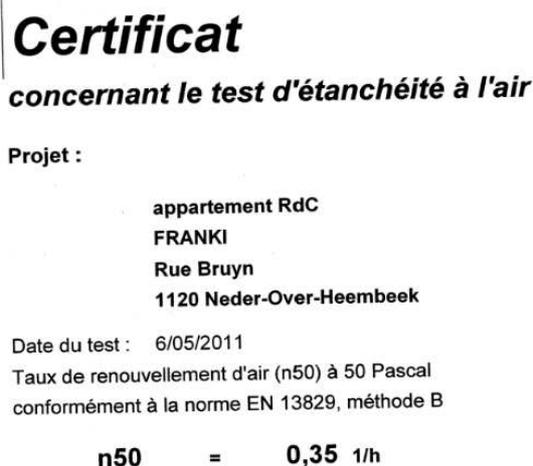
Figure 12 : Test d'infiltrométrie mené par ISOPROC [14]
