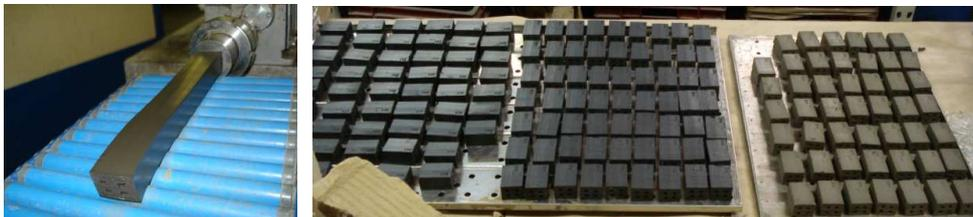
*Figure 10 : Extrusion des briquettes perforées*
