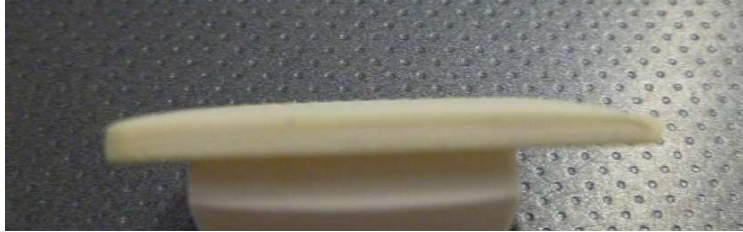
Figure 4: coupe transversale d'un SINUS+ présentant un effet "banane"
