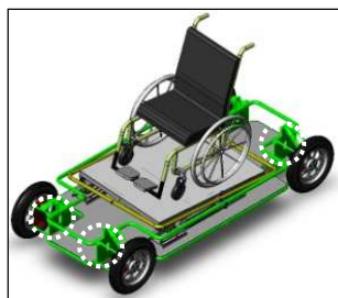
Figure 1b : Système de suspension
