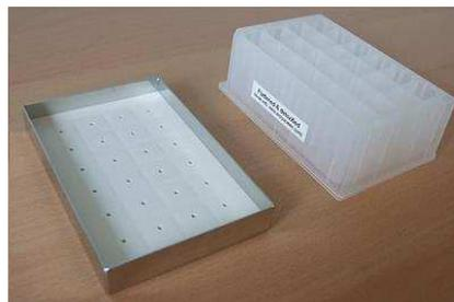
*Figure 4 : Microplaque de culture du system Duetz [9]*
