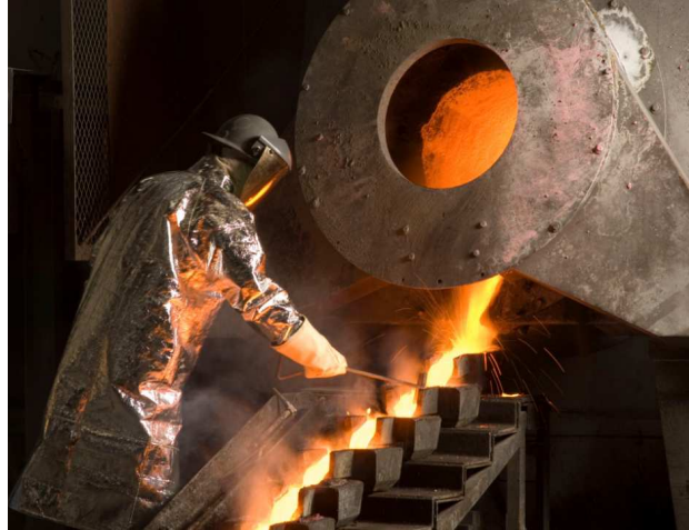
Figure 3 : Coulée : formation des lingots après extraction de l'or
