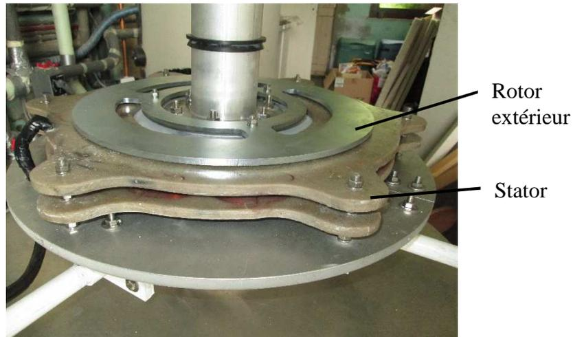
*Figure 8 : Alternateur construit*
