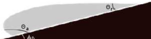
Figure 2 : Angle d'avancée et de recul sur une pente inclinée à l'angle de glissance
