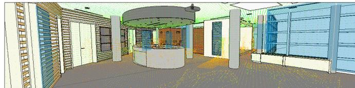
*Figure 10 : Vue intérieure du modèle, superposé au nuage de points*
