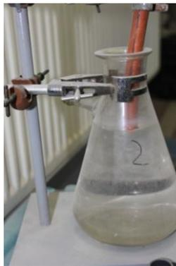
Figure 6: Système d'évacuation du biogaz
