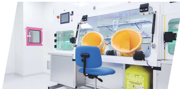
Figure 1 : Photo d'une salle propre munie d'un équipement aéraulique de laboratoire (Isolateur dans ce cas-ci)
