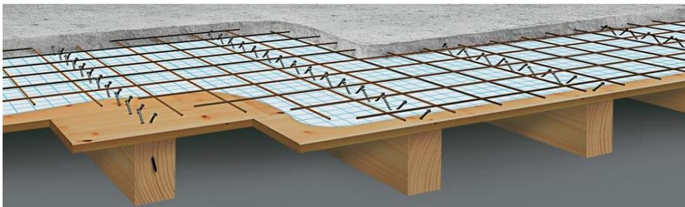
Figure 2 : Plancher mixte connecté par des connecteurs vis [2]
