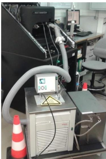
*Figure 4 : Branchement du module en température au nanoindenteur*
