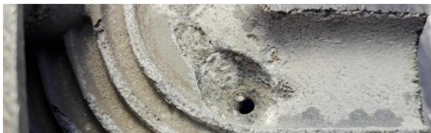
Figure 4 : Piqûration d'un corps de chauffe de chaudière aluminium-silicium. Corrosion généralisée de l'aluminium et confinement de la piqûre par les oxydes d'aluminium. Illustration de l'auteur.
