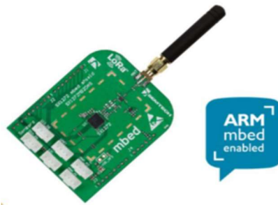
Figure 12- Emetteur/ Transmetteur LoRa (SX1272) [29].
