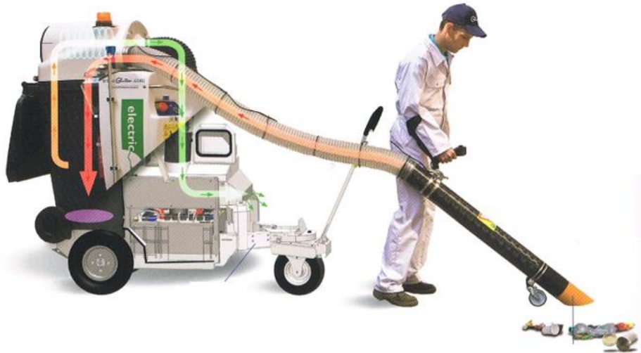
Figure 1 : Passage de l'air à travers le Glutton Collect.
