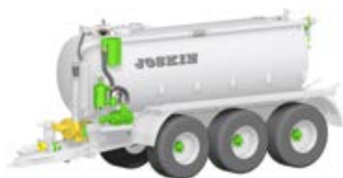
Figure 3 : Représentation d'un épandeur de lisier équipé d'un système d'aspiration traditionnel
