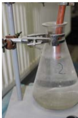
Figure 6: Système d'évacuation du biogaz
