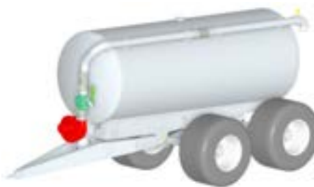
Figure 4 : Représentation d'un épandeur de lisier équipé d'un système d'aspiration Venturi
