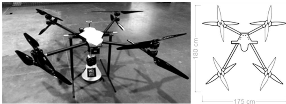
Figure 1 : le drone construit sur mesure pour cette recherche est capable de soulever des charges de 20 à 40 kg.
