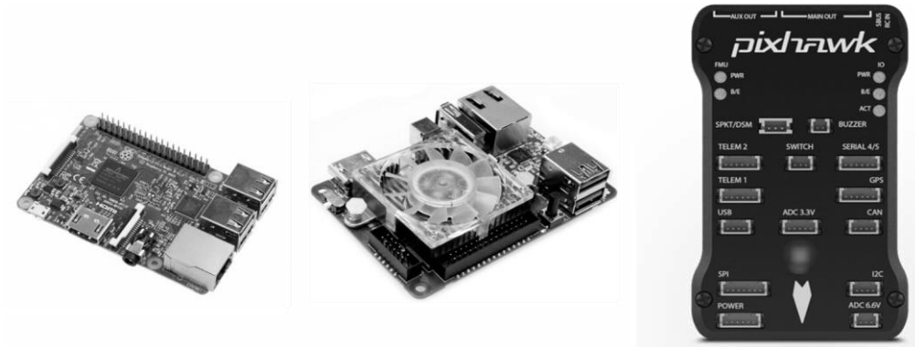
Figure 6 : de gauche à droite RaspberryPi 3, Odroid XU4 et PixHawk [4]
