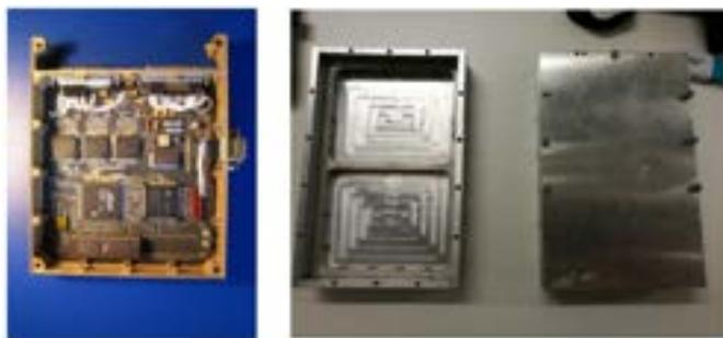
Figure 4 – A gauche, un module "avec oreilles", à droite, un module sans "oreilles" [5]
