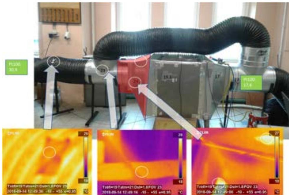
Figure 19 : Températures de la conduite et la pièce de forme en mode chauffage
