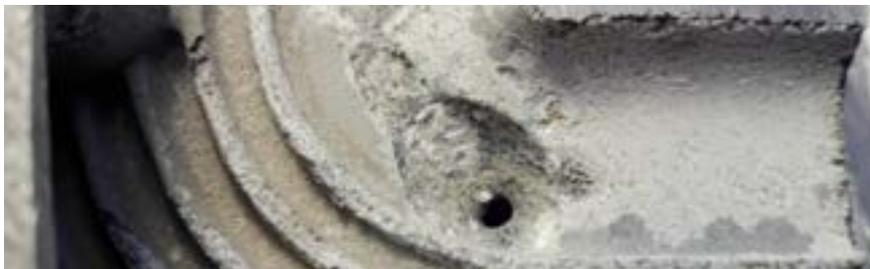
Figure 4 : Piqûration d'un corps de chauffe de chaudière aluminium-silicium. Corrosion généralisée de l'aluminium et confinement de la piqûre par les oxydes d'aluminium. Illustration de l'auteur.
